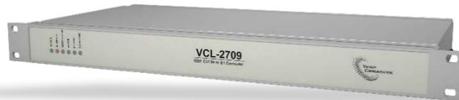
Le VCL-2709, convertisseur IEEE C37.94 vers E1, est un convertisseur de protocole durci pour les sous-stations, qui convertit l'interface IEEE C37.94 en une interface E1 pour permettre la transmission de l'IEEE C37.94 sur un réseau E1 / SDH.
