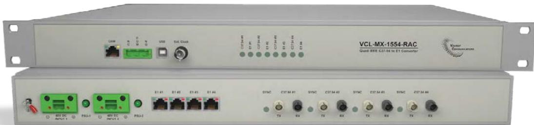
Le VCL-MX-1554-RAC, convertisseur quadruple (4x) IEEE C37.94 vers E1, est un convertisseur de protocole robuste et durci pour les sous-stations, capable de convertir jusqu'à 4 interfaces IEEE C37.94 en 4 interfaces E1 à 2,048 Mbps, et inversement. Le VCL-MX-1554-RAC, convertisseur IEEE C37.94 vers E1, prend en charge les applications point à point ainsi que point à multipoint. Il est conçu pour l'interconnexion des relais de protection différentielle IEEE C37.94 sur un réseau E1/SDH.
