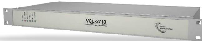
Le VCL-2710, convertisseur optique Multi-Mode vers Monomode IEEE C37.94, est un convertisseur robuste et durci pour les sous-stations, qui convertit un signal optique IEEE C37.94 Multi-Mode en Monomode. Cet équipement est conçu pour étendre le canal multi-mode IEEE C37.94 sur de longues distances en utilisant des fibres optiques monomodes.
